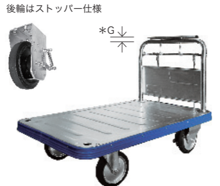
VB-HSD *ハンドルからレバーまでの高さ(G) : 30mm ・ハンドルに取り付けられたレバーを握ると、ブレーキが解除されます。
