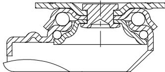
**取付金具:** LDAシリーズ - プレス鋼板製、自在旋回部内にダブルボールベアリング仕様、トッププレートの特別形状と歯付き球面ワッシャーによるボールプロテクション。自在旋回部はリベット固定済み。
